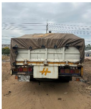
รูปที่ 2-16 การปิดคลุมรถขนส่งวัสดุก่อสร้าง
